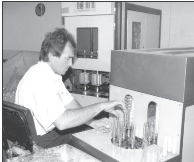
В цеха за раздуване на бутилки подготвят пластмасов амбалаж за олиото от новата реколта.
